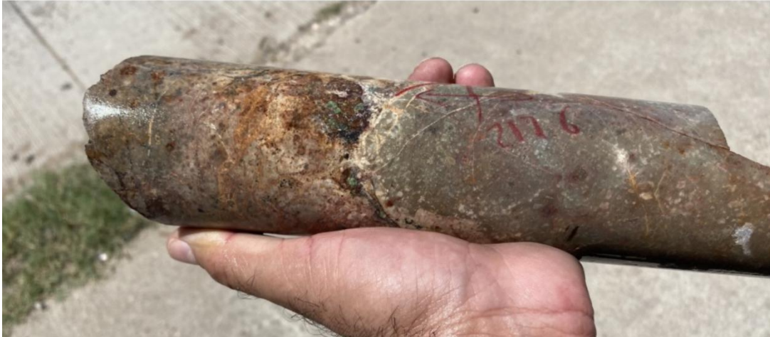
Foto 4- Bohrung SM20-30; verkieselter Kalkstein, Quarzbrekzie
