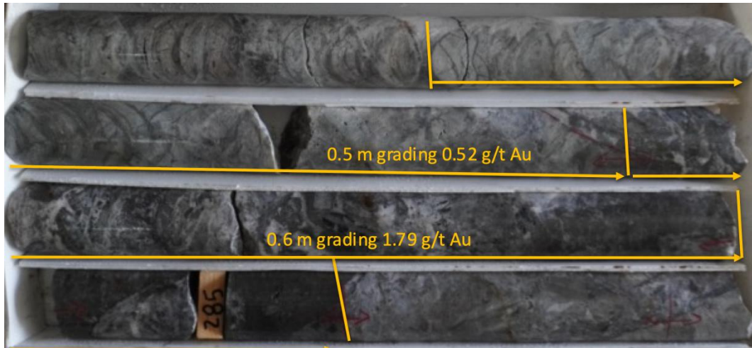
Foto 4- Bohrung SM20-30; verkieselter Kalkstein, Quarzbrekzie
