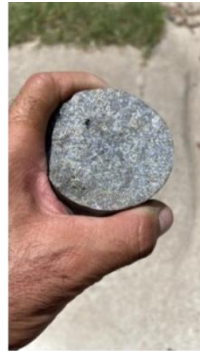
Hydrothermal Breccia 4.22 g/t Au
